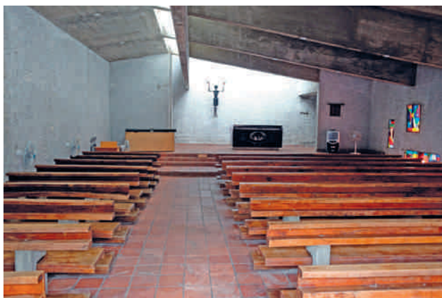
上圖—— 公東高工教堂（1960）戲劇性的採光手法，以高窗採光照亮祭壇主牆面
